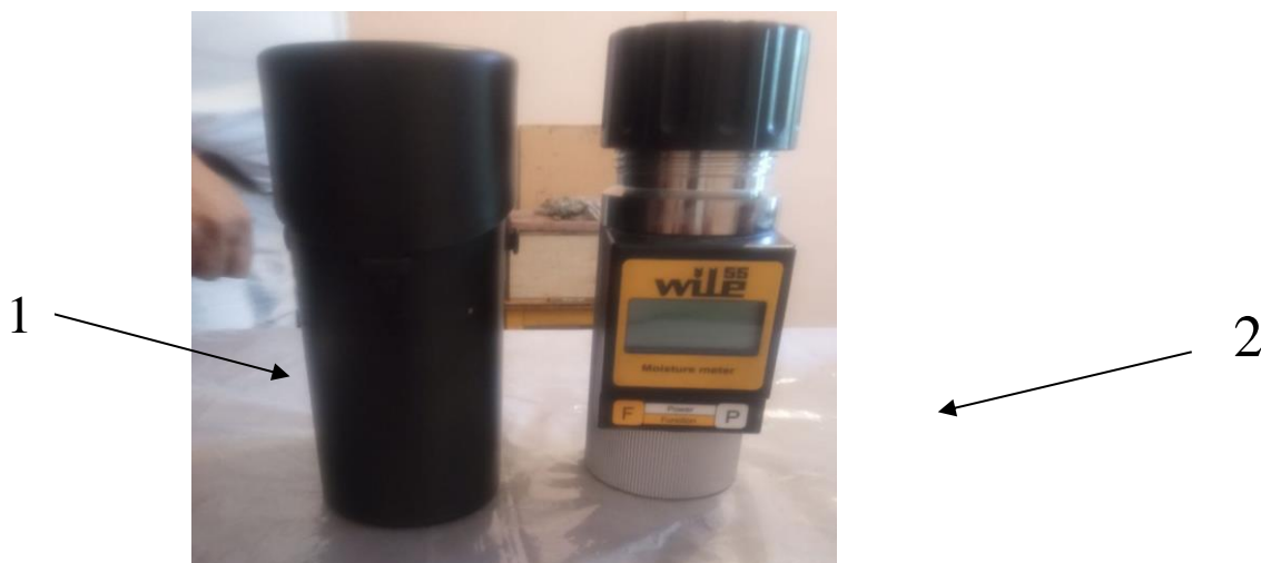
2-расм. 16 хил қишлоқ хўжалик маҳсулотларини намлигини электрон ўлчаши қурилмаси Россия федерацияси томонидан ишлаб чиқилган.
