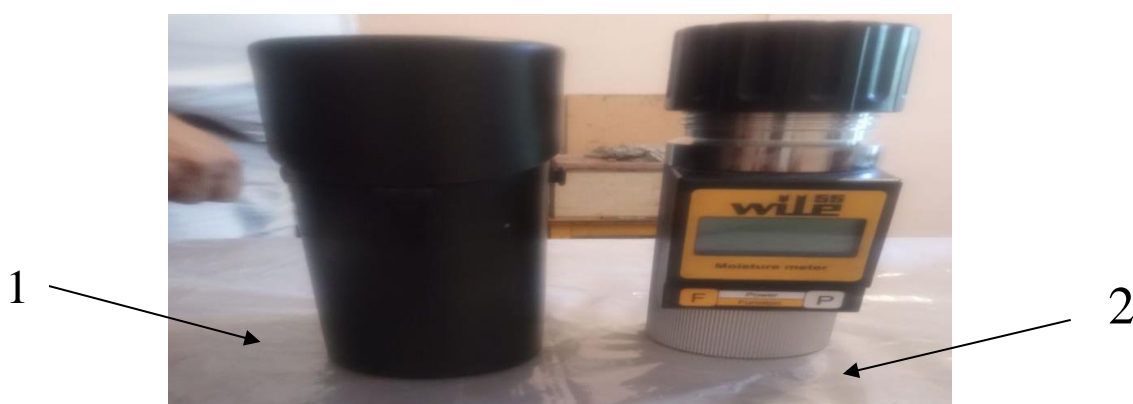
2-расм. 16 хил қишлоқ хўжалик маҳсулотларини намлигини электрон ўлчаш қурилмаси Россия федерацияси томонидан ишлаб чиқилган.
